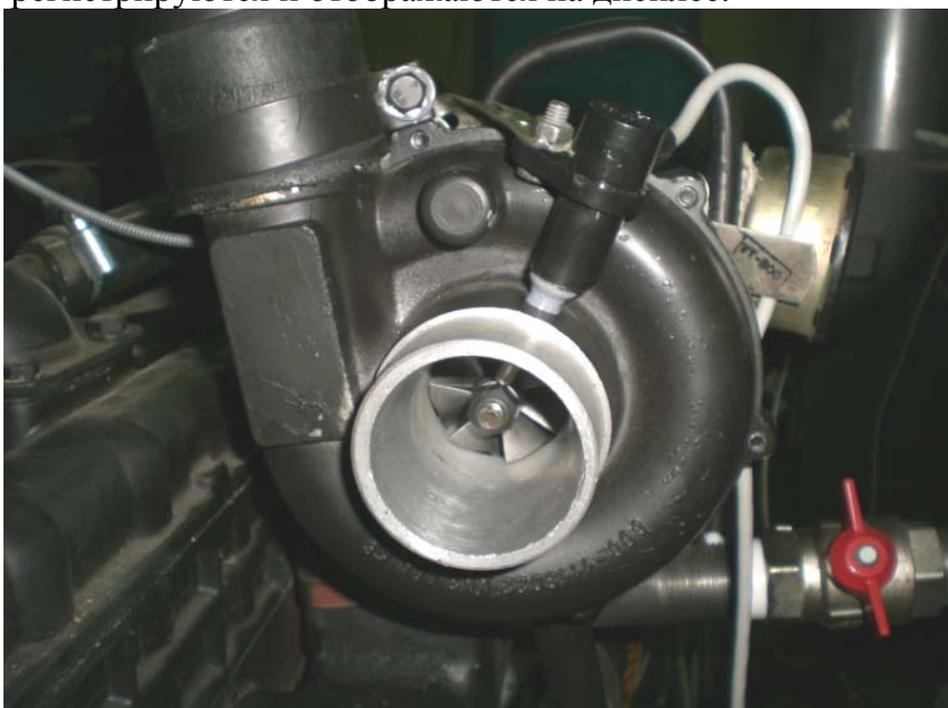
Рис. 3.18. Устройство измерения частоты вращения вала ТКР
