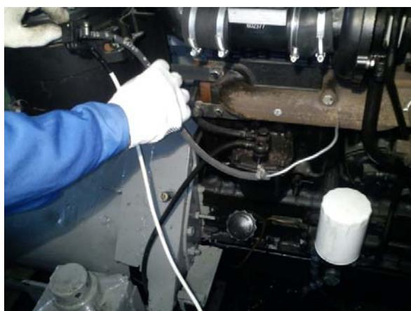
г) монтаж датчика давления в выпускной коллектор
