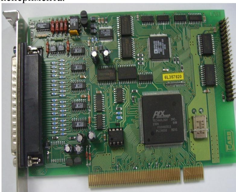
Рис. 3.6. Плата сбора данных L 783 фирмы ЗАО «Л КАРД»
