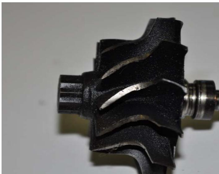
Рис. 1.2. Износ турбинного колеса в результате трения о неподвижные части ТКР
