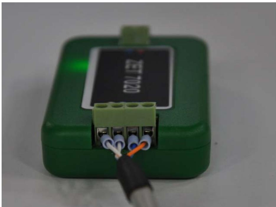
Рис. 3.11. Модуль ZET 7020 для измерения температуры с помощью термопар, вид со стороны подключения к измерительной сети
