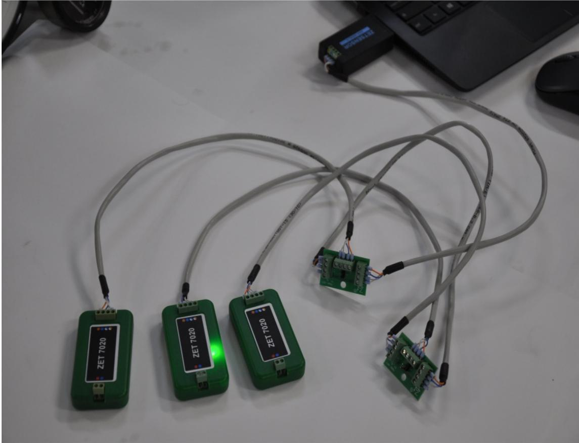
Рис. 3.9. ZET 7020 ТермоТС-CAN интеллектуальный термодатчик термопары с интерфейсом CAN
