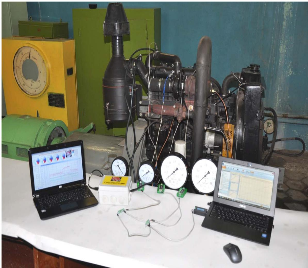
Рис. 3.20. Измерительная система по изучению показателей работы системы наддува, установленная на двигателе Д-245-35 и ТКР-6.1 с использованием обкаточно-тормозного стенда КИ 5543 ГОСНИТИ
