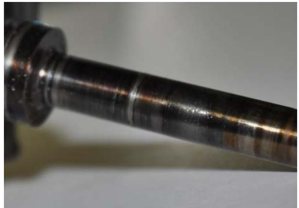
Рис. 1.4. Механический износ на валу турбокомпрессора
