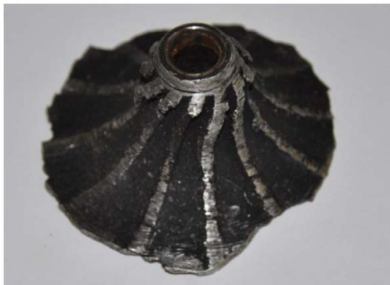
Рис. 1.5. Разрушение компрессорного колеса в результате попадания постороннего предмета
