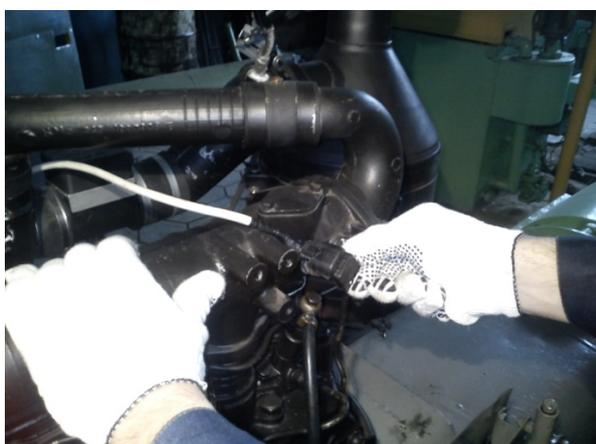
в) установка датчика давления и термопары во впускной коллектор
