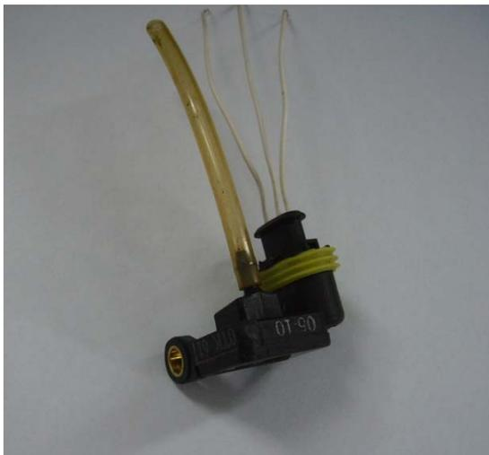
Рис. 3.4. Датчик давления наддува 47.3829
