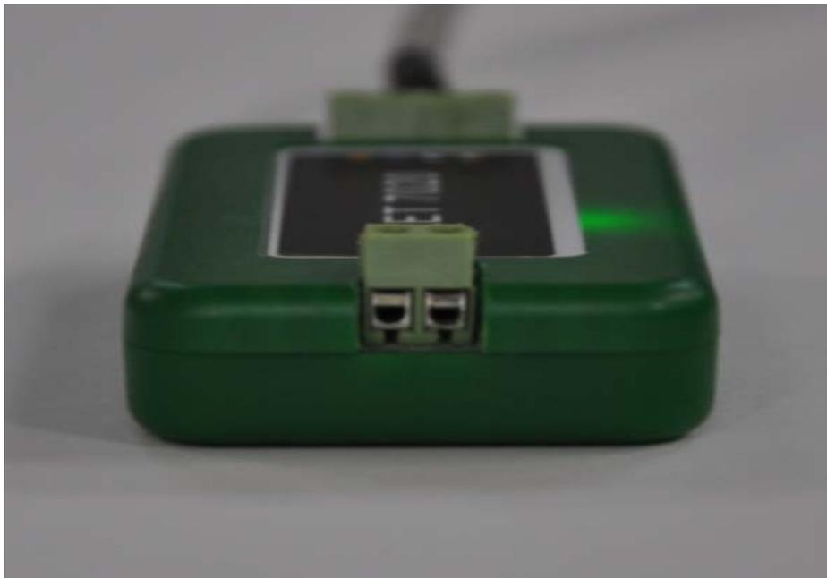
Рис. 3.10. Модуль ZET 7020 для измерения температуры с помощью термопар, вид со стороны подключения датчика температуры
