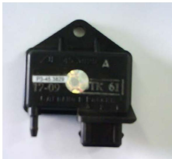
Рис. 3.5. Датчик абсолютного давления 45.3829
