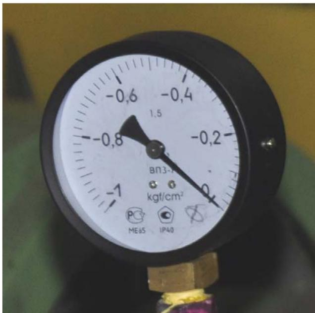
Рис. 3.17. Моновакуумметр ВПЗ-Ус
