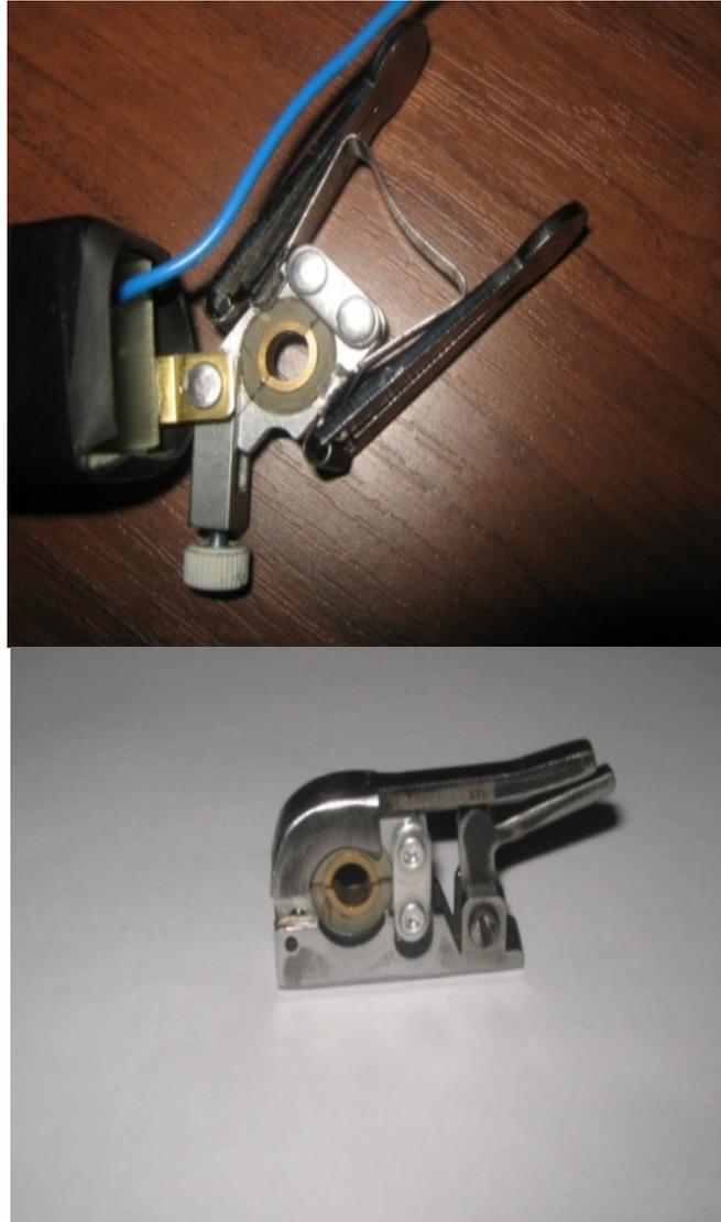
Рис. 5.36. Датчики давления топлива с пружинным и эксцентриковым зажимом
