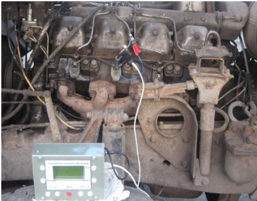
Рис. 5.37. Внешний вид встроенной системы диагностирования (продолжение)
