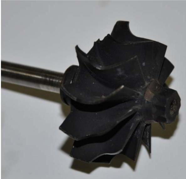
Рис. 1.3. Обрыв лопатки вследствие попадания постороннего предмета
