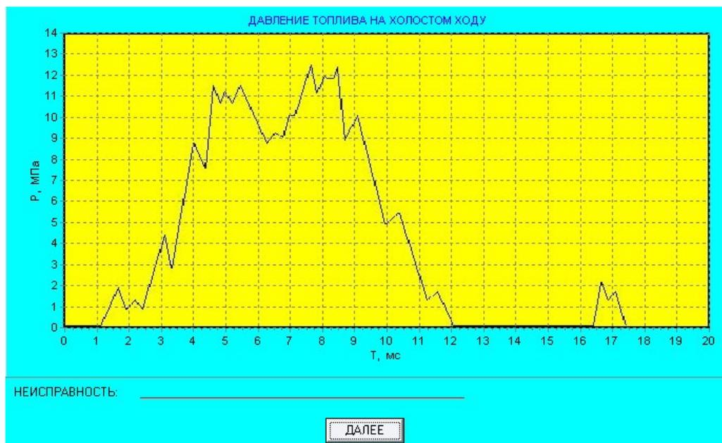
Рис. 5.11. График давления при нормальной работе ЯМЗ (холостой ход)
