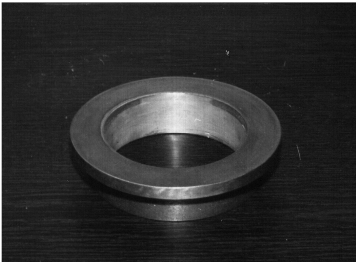
Рис. 4.6. Зона перехода от покрытия к основе, полученная в результате проведения эксцентричной обработки на токарном станке
