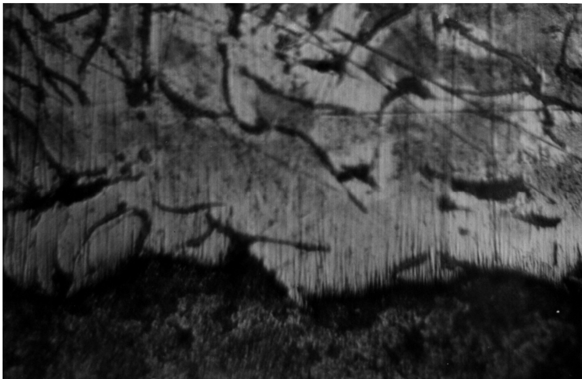
Рис. 4.10. Граничная зона между чугуном СЧ 18 и цинковым гальванопокрытием ( \times 400 ); анодное травление чугуна: D_a = 30 \text{ А/дм}^2 ; \tau = 35 \text{ с} ; период начального осаждения: D_{кн} = 10 \text{ А/дм}^2 ; \beta = 1,25 ; T = 303 \text{ К} ; рН = 3,5
