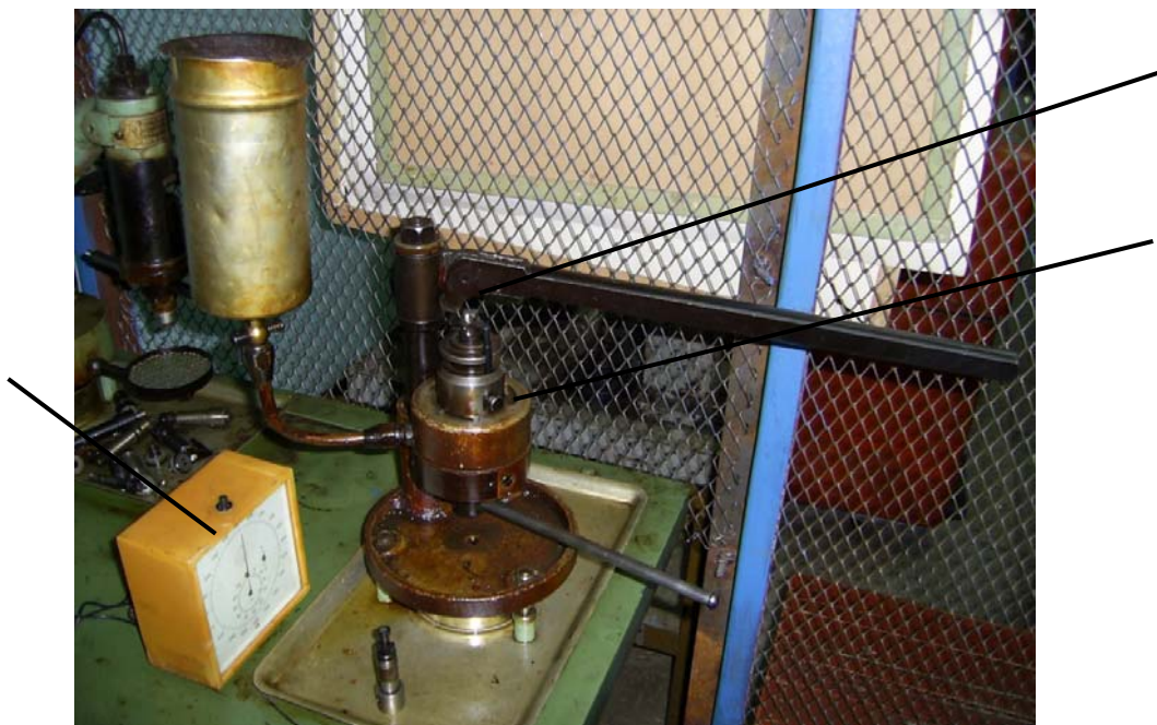
Рис. 3.4. Общий вид оборудования для проверки гидравлической плотности плунжерных пар ТНВД: 1 – прибор КИ-759; 2 – плунжерная пара; 3 – секундомер электронный
