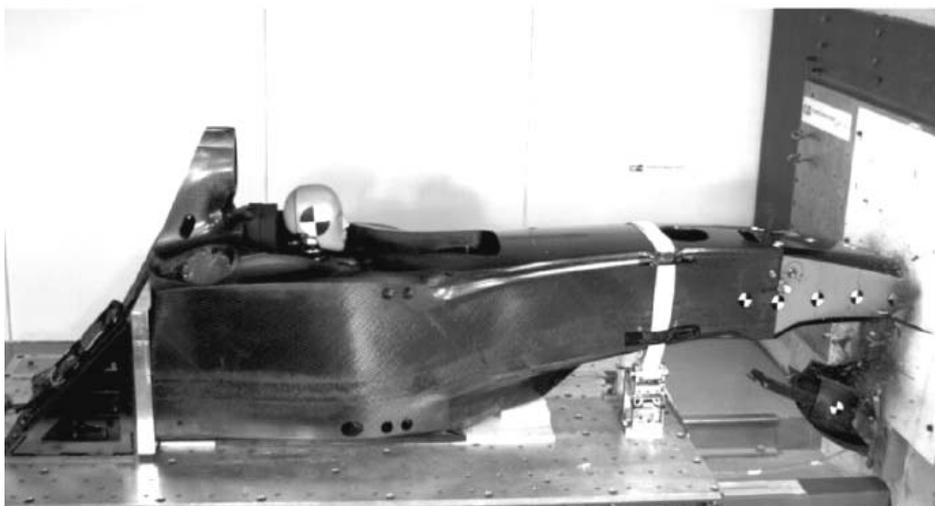
Рис. 4.25. Испытательная установка болида на лобовое столкновение
