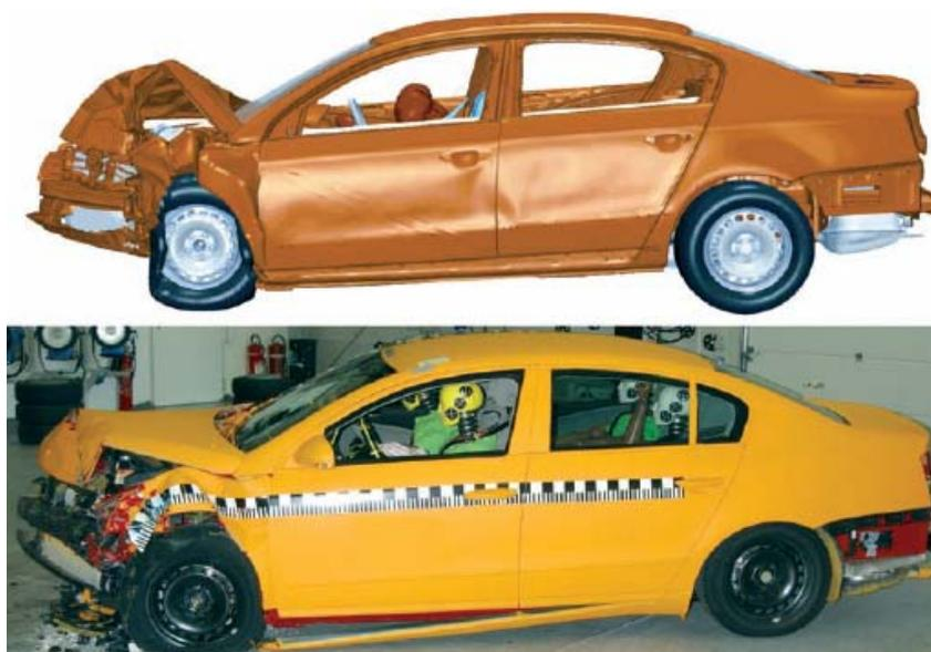
Рис. 4.31. Сравнительный анализ разрушений автомобиля, выполненный компанией Volkswagen
