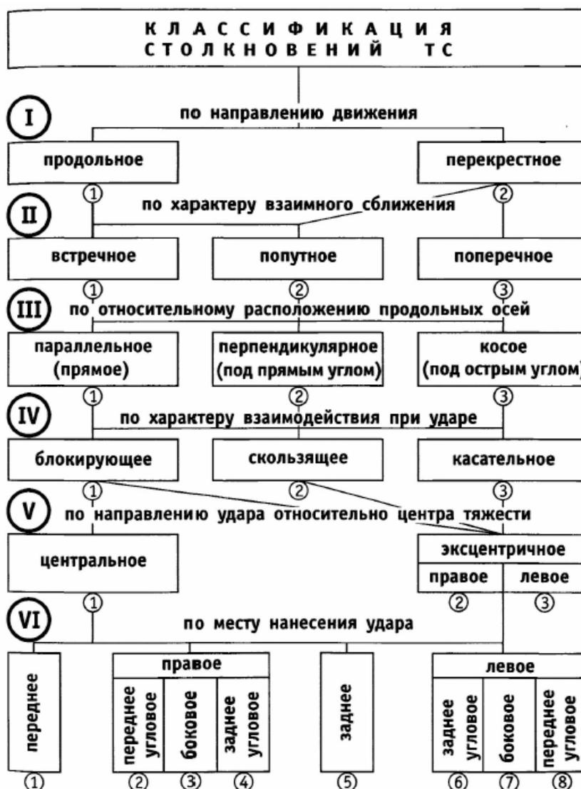
Рис. 2.1. Классификация видов столкновения ТС
