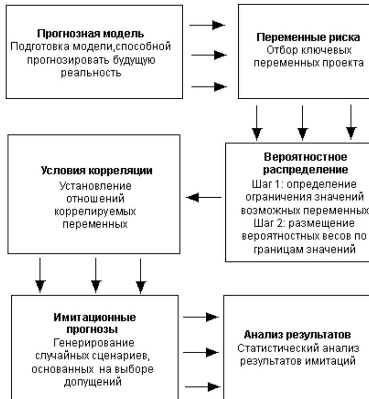
Рис. 1.5. Общая схема метода Монте-Карло
