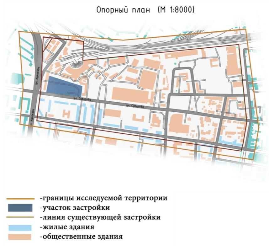
Рис.1. Опорный план М 1:8000
