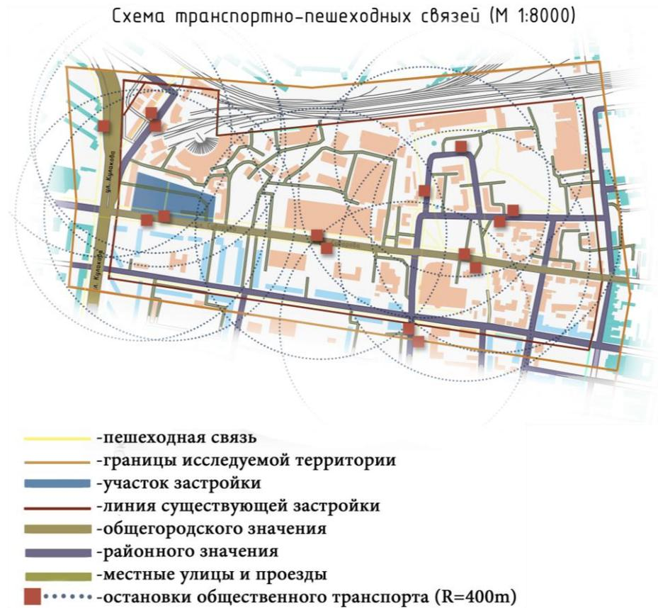
Рис.2. Схема транспортно-пешеходных связей М 1:8000
