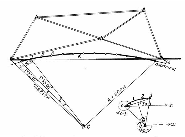
Рис. 22. Схема арочной плотины и пунктов геодезической сети
