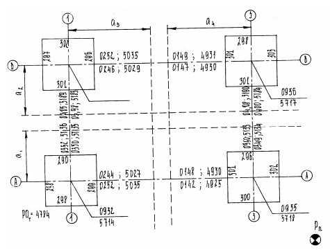
Рис. 28. Журнал плановой исполнительной съемки колонн
