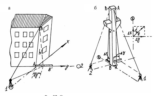
Рис.32. Схема измерения крена способом вертикального проецирования с помощью теодолита: а – здания; б – колонны
