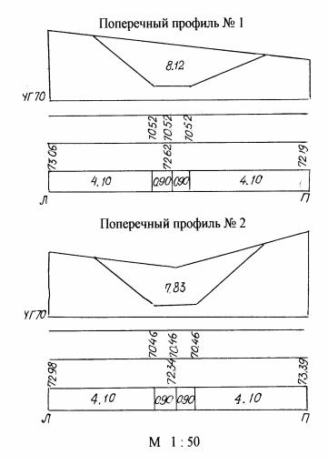
Рис.7. Поперечные профили траншеи самотечного канализационного трубопровода
