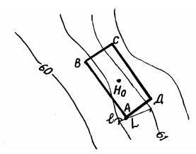
Рис.13. Определение отметок углов здания по горизонталям
