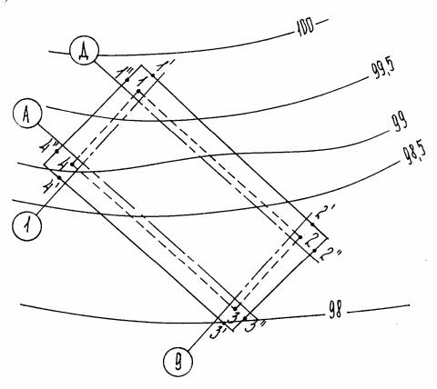
Рис. 17. Фрагмент плана строительного участка с контурами котлована
