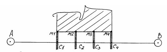
Рис.33. Схема наблюдения за сдвигами створным методом с помощью рейки
