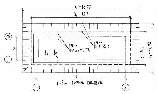
Рис.15. Схема контура котлована
