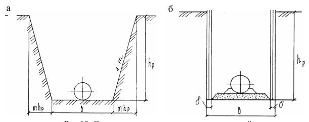
Рис. 19. Схема для определения размеров траншей
