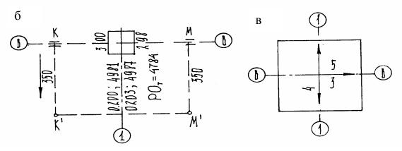
Рис.27. Фрагменты плановой исполнительной съемки колонн: а – схема съемки; б – журнал плановой исполнительной съемки; в – исполнительный чертеж
