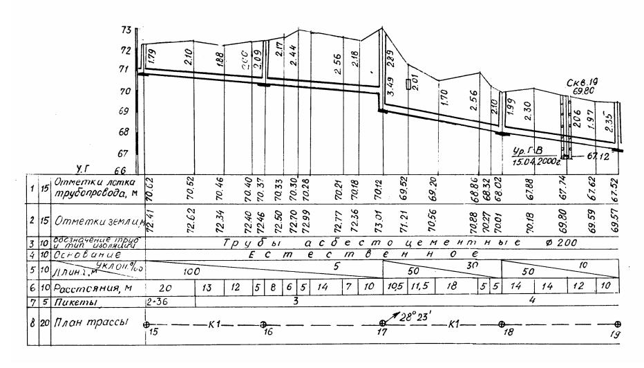
Рис. 6. Продольный профиль трассы самотечного канализационного трубопровода
