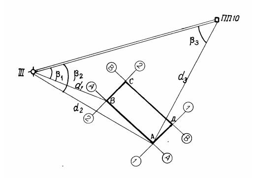
Рис.10. Схема разбивки основных осей здания
