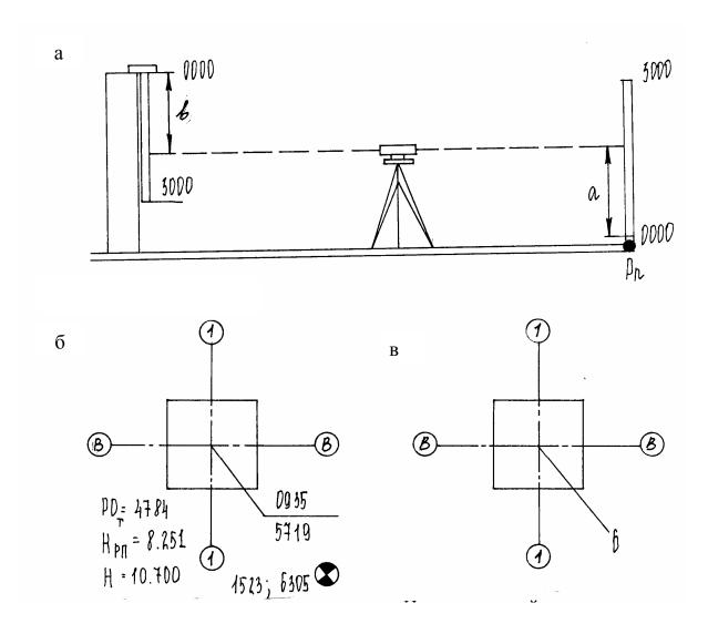
Рис.29. Фрагменты высотной исполнительной съемки колонн здания: а – схема съемки; б – журнал съемки; в – исполнительный чертеж съемки
