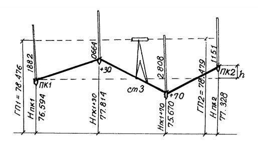
Рис.3. Схема нивелирования на станции 3
