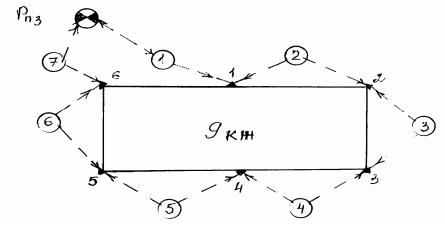
Рис. 30. Схема нивелирного хода и расположения осадочных марок
