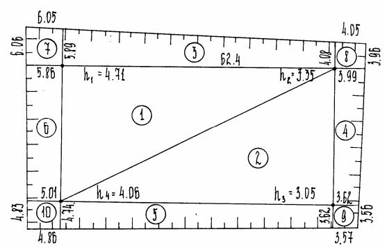
Рис. 20. Схема определения объемов земляных работ
