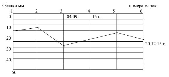
Рис. 31. График осадки фундаментов
