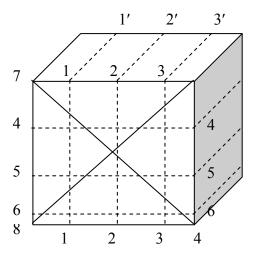
Рис.24. Схема измерения размеров конструкции
