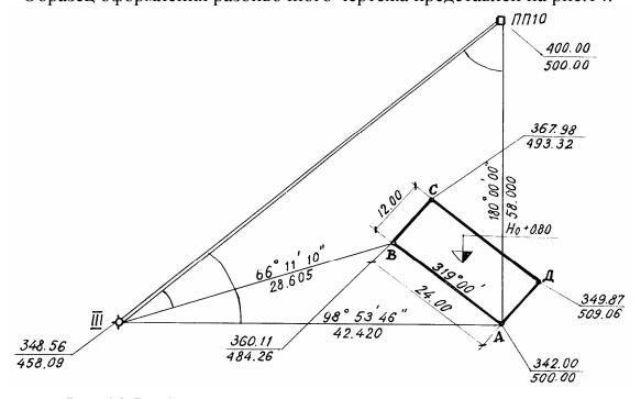
Рис. 14. Разбивочный чертеж для выноса в натуру осей здания
