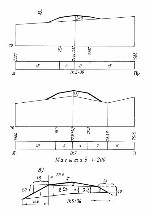
Рис. 5. Поперечный профиль автодороги (a) и схема для вычисления площади поперечного сечения насыпи (б)
