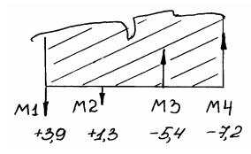
Рис.34. Схема сдвига деформационных марок
