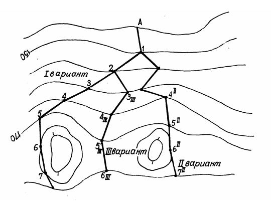
Рис.1. Схема построения линии нулевых работ
