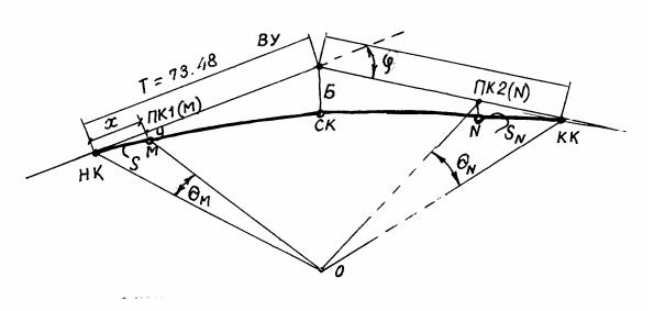
Рис. 9. Схема разбивки круговой кривой
