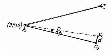
Рис.12. Построение углов с повышенной точностью
