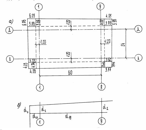
Рис.18. Разбивочный чертеж котлована: а – общий вид; б – схема определения расстояний в углах котлована
