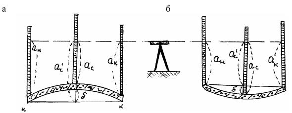
Рис. 26. Схема нивелирования точек поверхности стеновой панели
