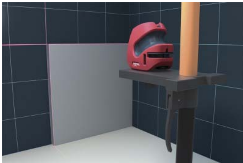
Рис.55. Лазерный нивелир «Condrol MicroX» проецирует классический крест
