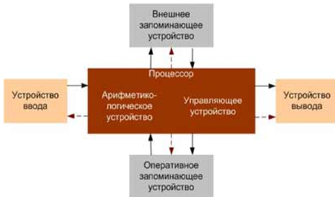
Рис. 1. Классическая архитектура фон-неймановской ЭВМ
