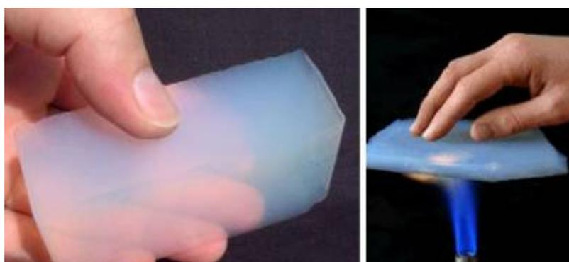
Рис. 2.6. Образец аэрогеля
