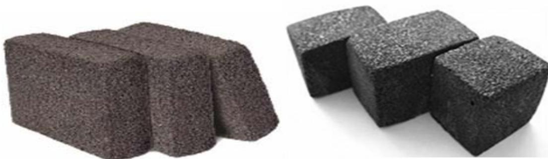
Рис. 1.12. Гранулированный и блочный пеноцеолит
