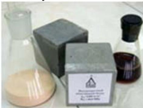
Рис. 2.16. Образцы высокопрочного бетона перед испытаниями
