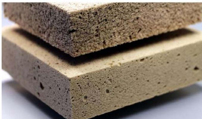
Рис. 2.23. Пенопласт изготовленный из древесины
