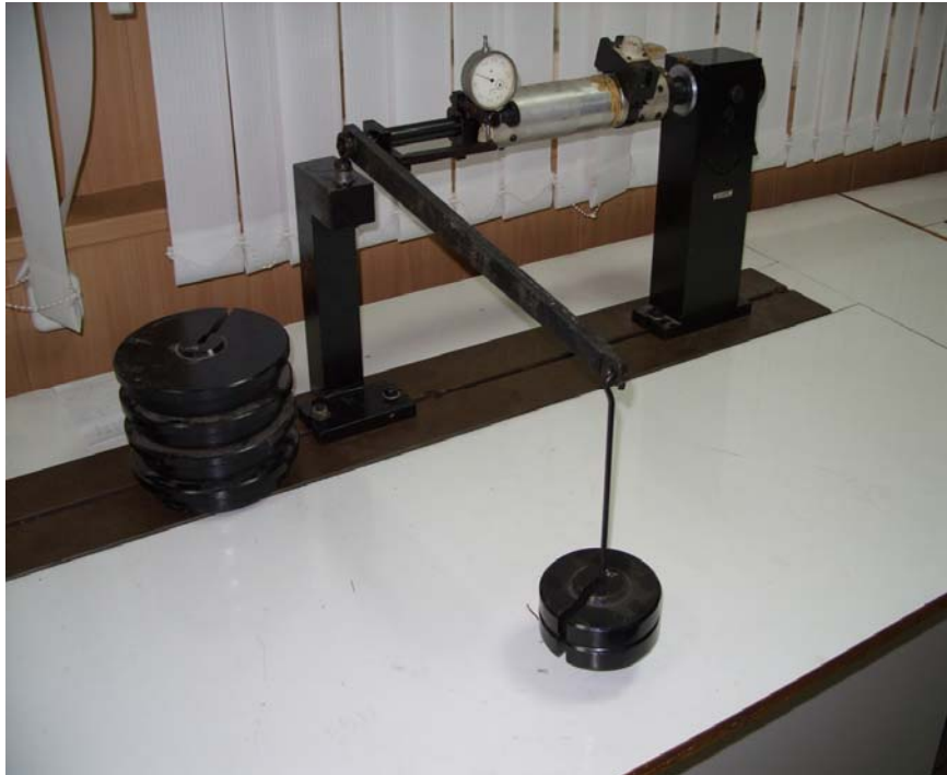
Рис. 4.8. Фотография установки для испытания на кручение
