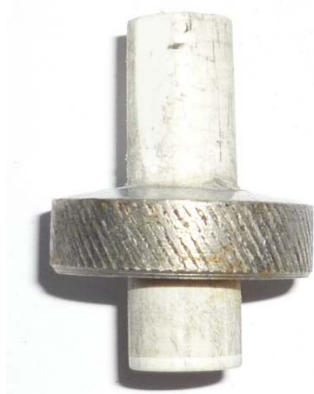
Рис. 2.4. Миниареометр для определения предела текучести тонкодисперсных смесей
