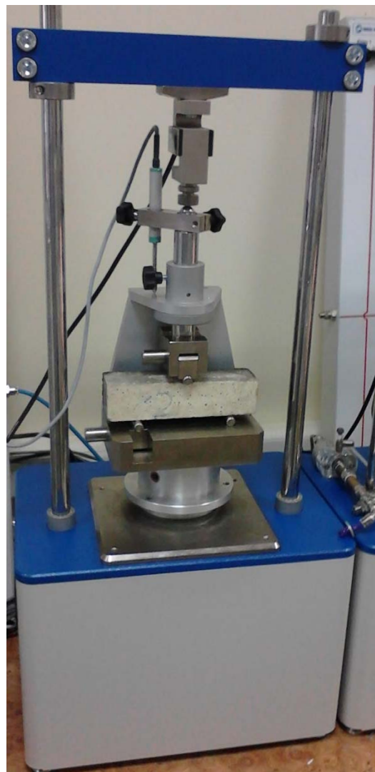
Рис. 2.8. Установка для определения трещиностойкости «АСИС-1»
