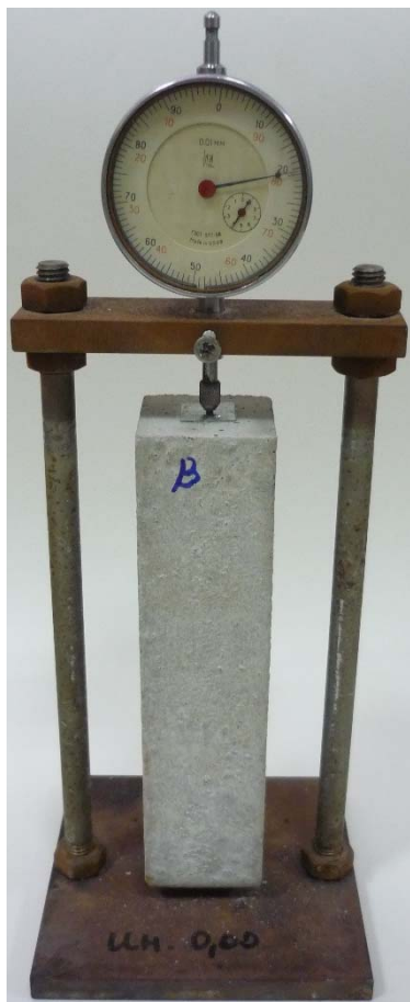
Рис. 2.7. Индикаторная стойка для определения воздушной усадки и набухания призм 40×40×160 мм
