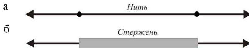
Рис. 1.6. Статическая эквивалентность растянутой нити и жесткого стержня
