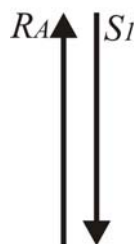
Рис. 1.26. Векторный многоугольник для узла I ( |\bar{S}_1| = |\bar{R}_A| )
