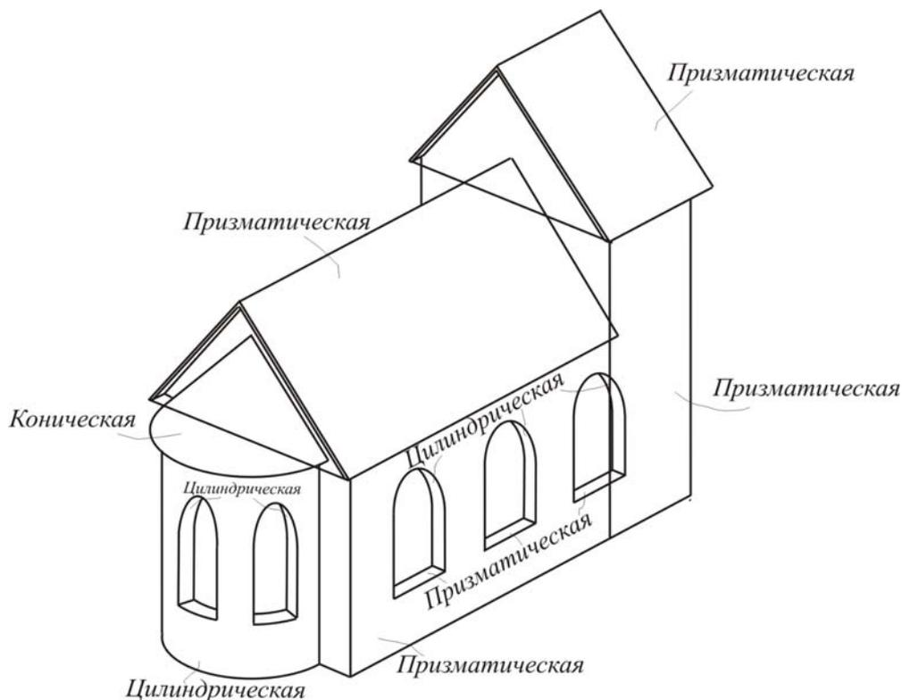
Рис. 154. Геометрические поверхности, образующие архитектурный объект
