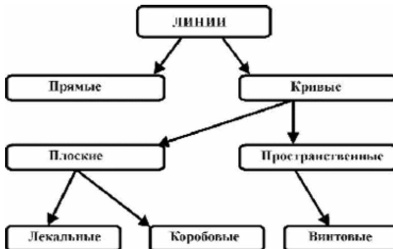
Рис. 11. Схема классификации линий
