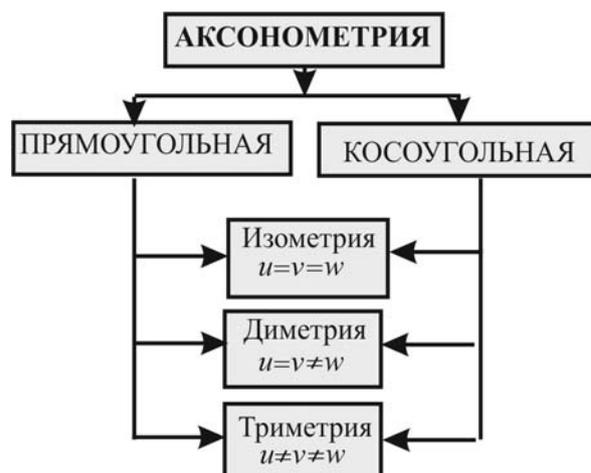
Рис. 196. Схема классификации изометрий по коэффициентам искажения
