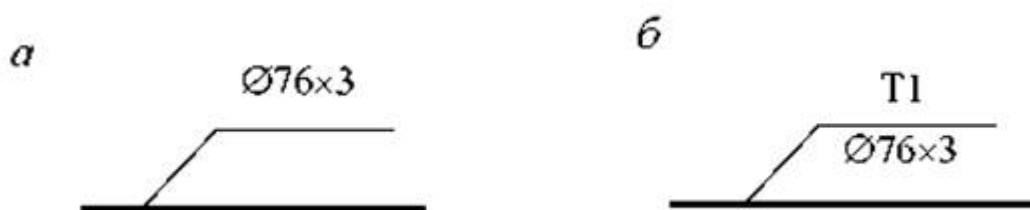
Рис. 6. Указания размера диаметра трубопровода
