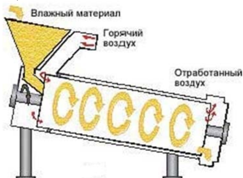
Рис.39. Схема сушилки барабанного типа
