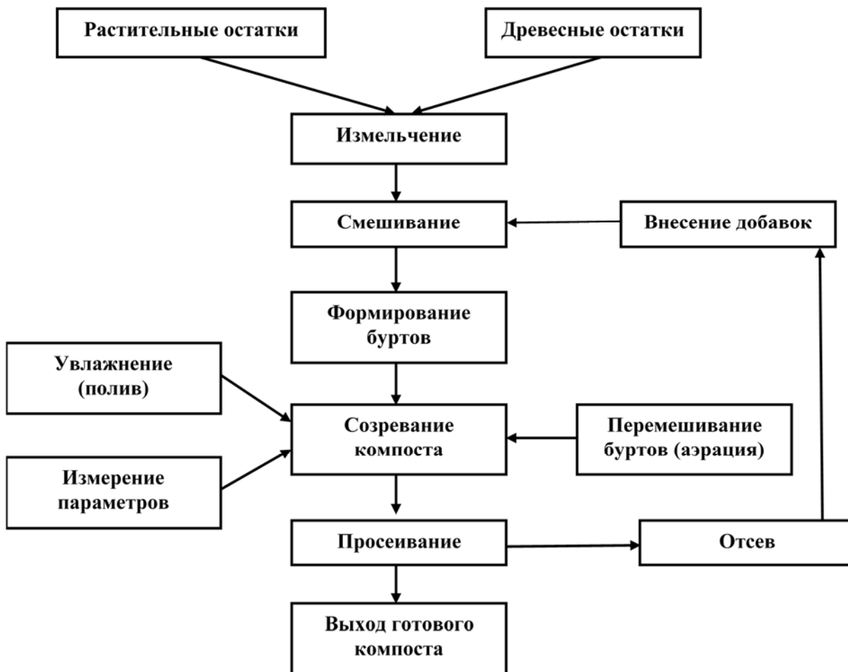
Рис. 2. Схема процесса компостирования древесно-растительных отходов
