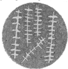
Рис. 12.4. Литая \alpha -латунь с 30 % цинка (типа Л70) (схема микроструктуры)
