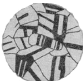
Рис. 12.5. Деформированная и отожженная латунь (схема микроструктуры)
