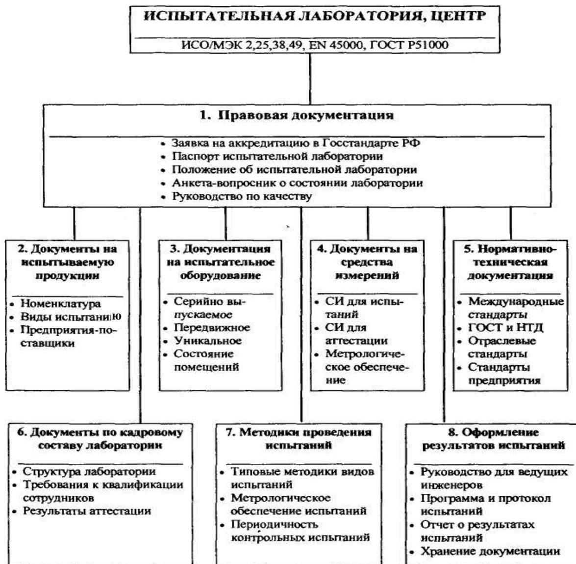
Рис. 4. Документация для аккредитации и функционирования испытательных лабораторий
