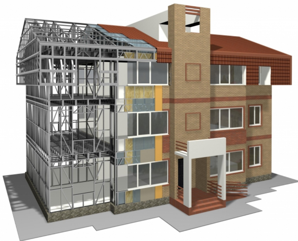
Рис. 2.10. Дом на металлическом каркасе
