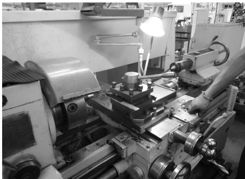
Рис. 4.51. Токарный станок 16K20 с установочной пластиной под резец из вибро-, звукопоглощающего ПКМ
