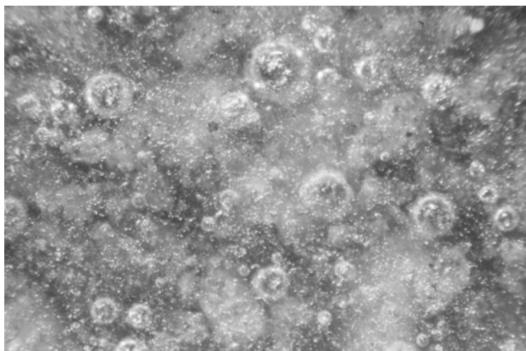
Рис. 3.9. Переход перколяционного каркаса в решетчатую упаковку в эпоксиполиуретановом композите (x200)
