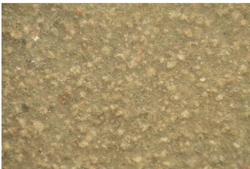
Рис. 4.14. Микроструктура образца из эпоксиполиуретанового композита, наполненного маршалитом ( \times 70 ): ЭД-20 – 100 мас.ч.; ПЭПА – 16 мас.ч.; Сарэл А-04 – 4 мас.ч.; Сарэл Б-04 – 4 мас.ч.
