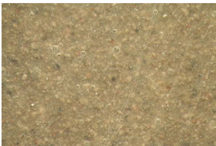
Рис. 3.3. Перколяционный каркас в эпоксиполиуретановом композите с объемным содержанием маршалита 0,233 (x70)
