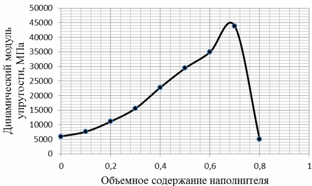
Рис. 4.12. Влияние объемного содержания маршалита на динамический модуль упругости эпоксиполиуретанового композита
