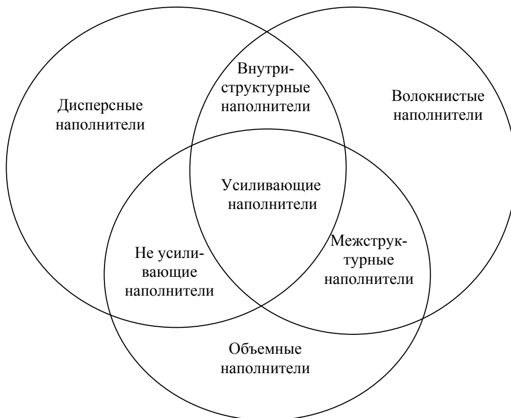
Рис.1.3. Схема классификации наполнителей по форме, размеру и влиянию на физико-механические свойства наполненных композиционных материалов
