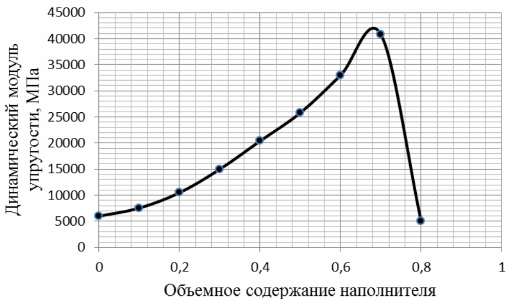
Рис. 4.13. Влияние объемного содержания диабаза на динамический модуль упругости эпоксиполиуретанового композита
