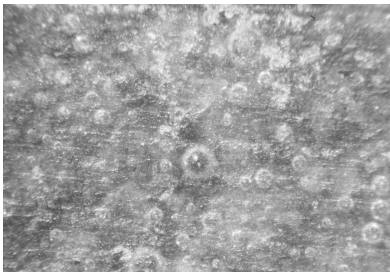
Рис. 4.45. Моделирование распределения наполнителя (маршалит) в эпоксиполиуретановом композите (образование перколяционного каркаса) x200
