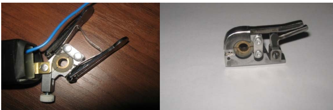
Рис. 6.10. Датчики давления топлива с пружинным и эксцентриковым зажимом
