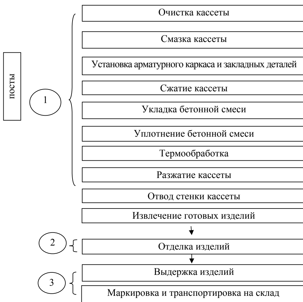
Рис. 1.29. Схема организации кассетного производства
