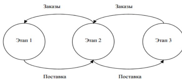
Рис.1.2. Вытягивающая система управления производством 15
