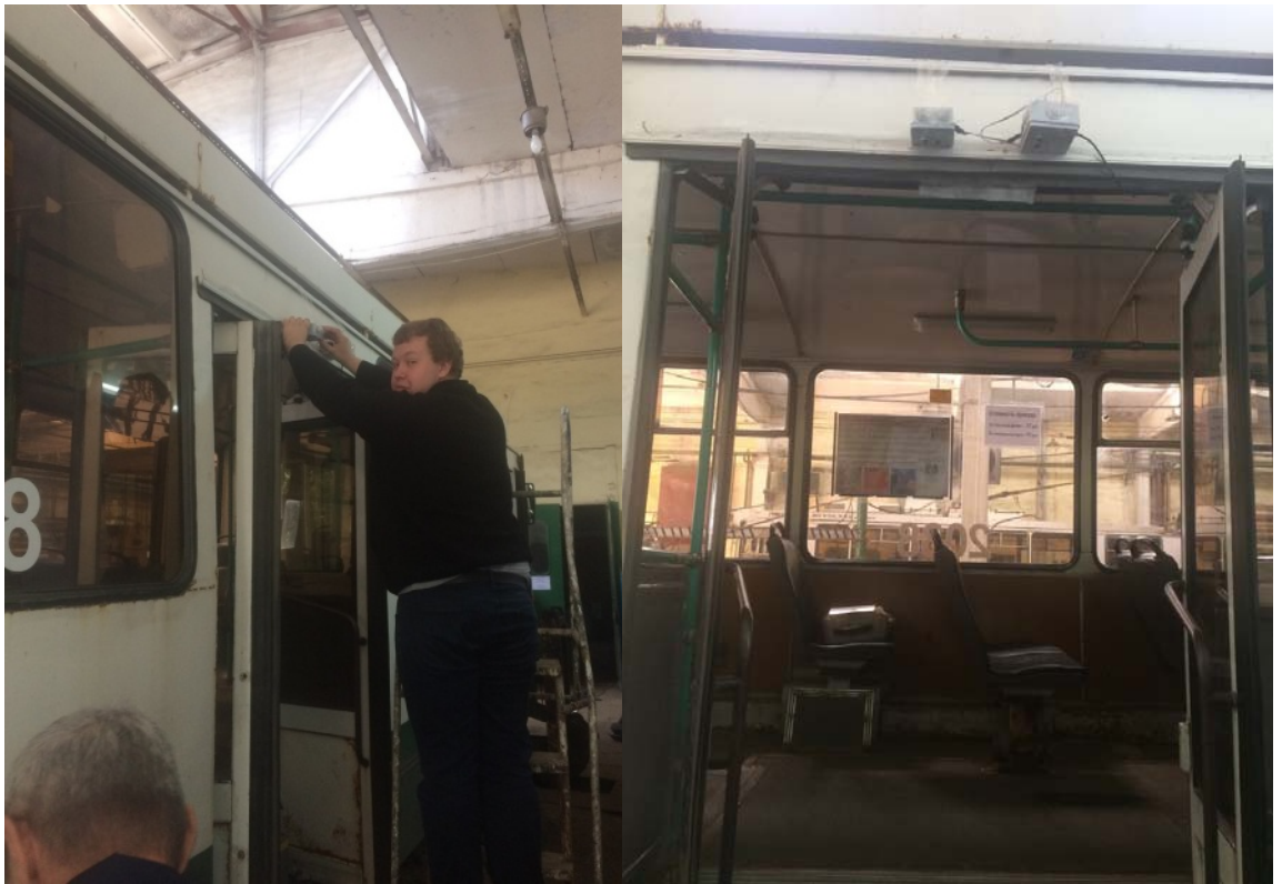
Рис.2.18 Схема установки датчиков над дверным проемом снаружи троллейбуса
