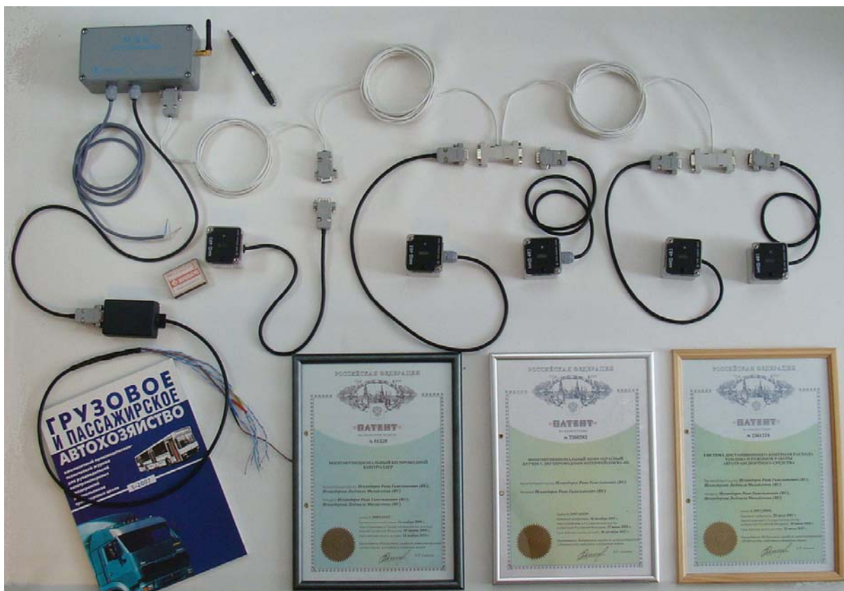
Рис. 1.9 Внешний вид системы: 1. МБК 2. БФС (Блок Формирования Сигналов) 3. Датчики МИД-485 4. Монтажный комплект проводов с разъемами
