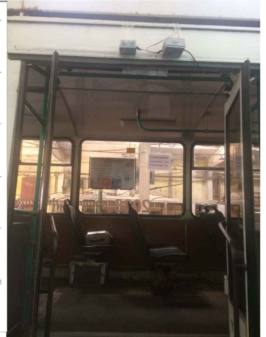
Схема установки датчиков над дверным проемом снаружи троллейбуса
