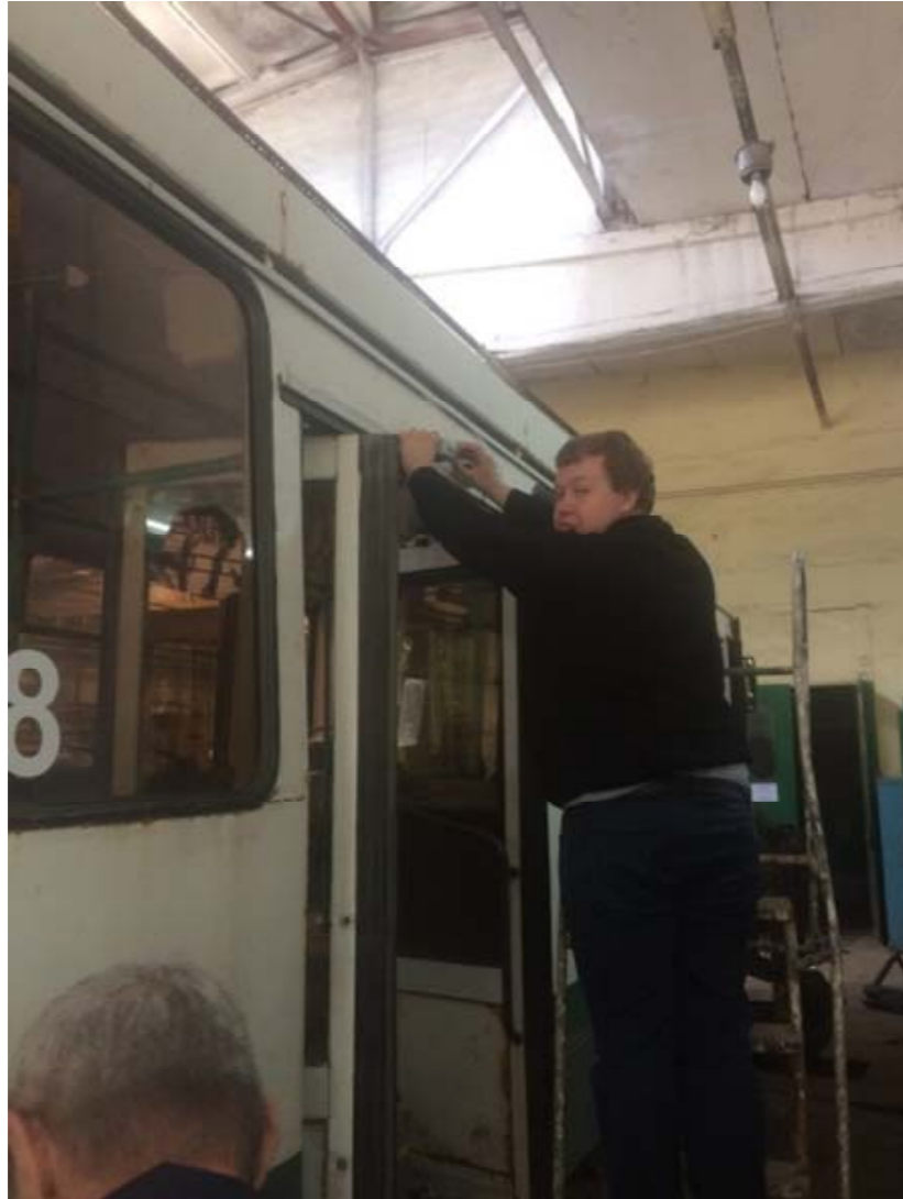
Установка датчиков над дверным проемом
