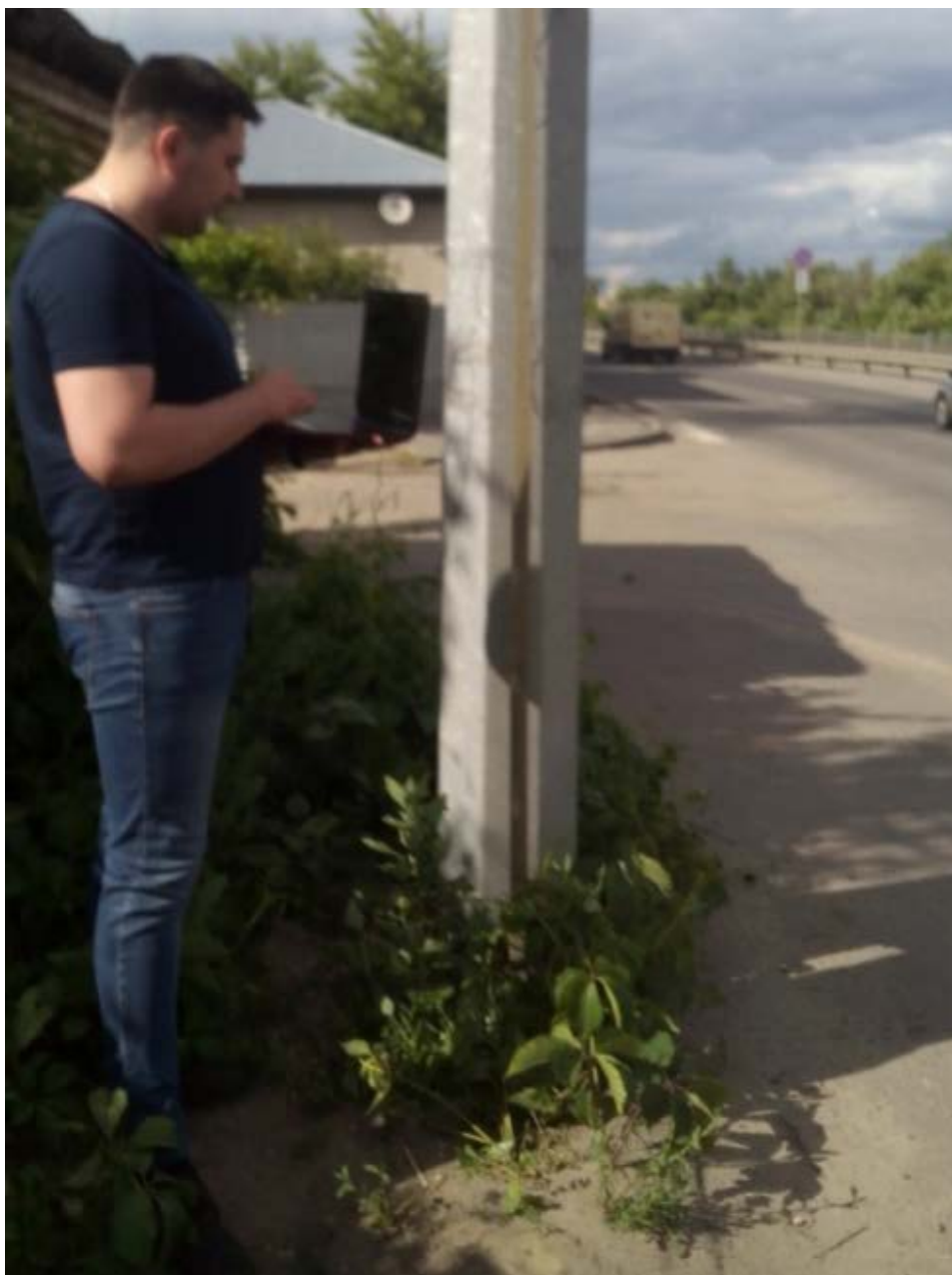
Рисунок 3.16 - Натурные исследования акустических характеристик транспортного потока с микрофоном «Линейного» типа № 2
