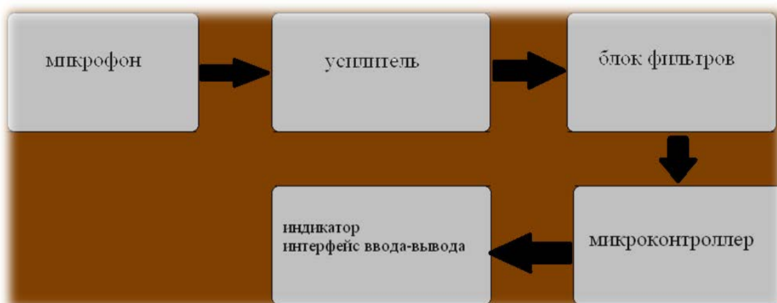
Рисунок 3.21 - Структурная схема пассивного акустического детектора контроля параметров транспортного потока
