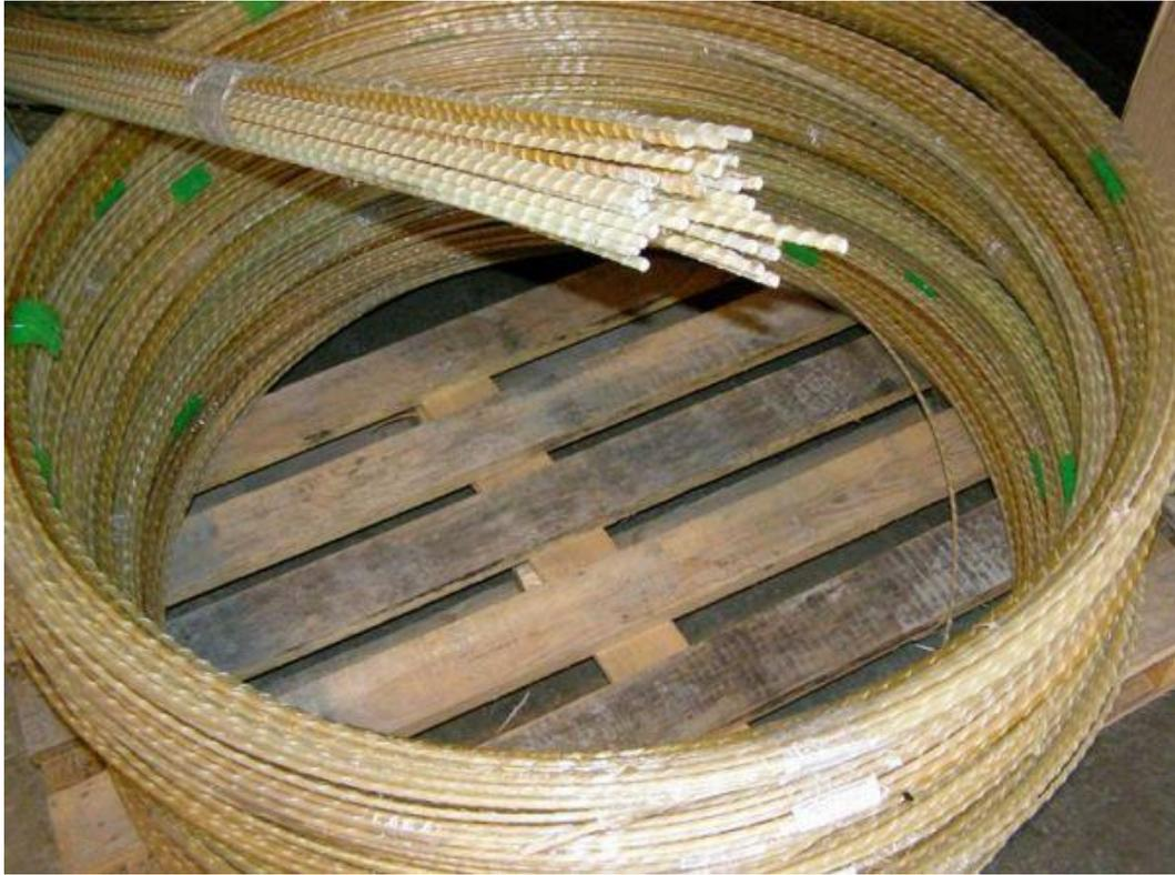
Рисунок 2.6 – Композитная арматура
