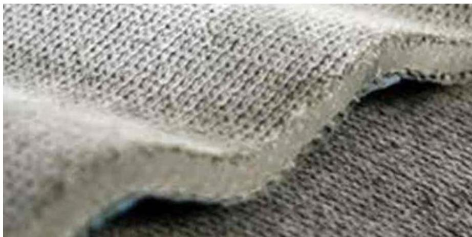
Рисунок 2.14 – Бетонный холст
