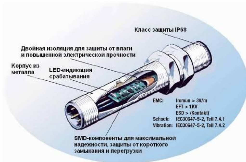
Рис. 3.13. Принцип работы индуктивного датчика положения
