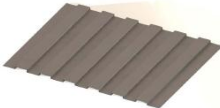
Рисунок 3.9 - Предлагаемая конструкция пола автомобиля с подштамповкой
