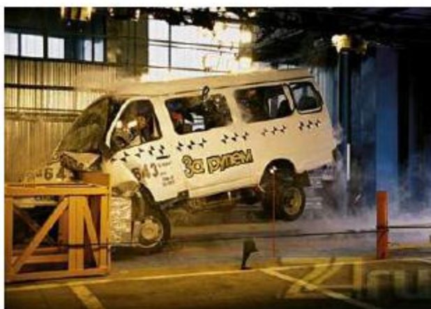
Рисунок 2.7. - Вид автомобиля «ГАЗель» в момент крэш-теста
