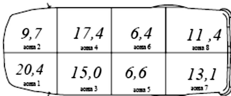
Рис. 2.1. Расположение зон травмоопасности в микроавтобусе "Газель" при лобовых столкновениях
