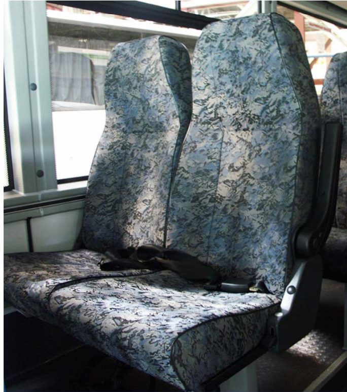
Штатная конструкция пассажирских сидений с двухточечными ремнями безопасности
