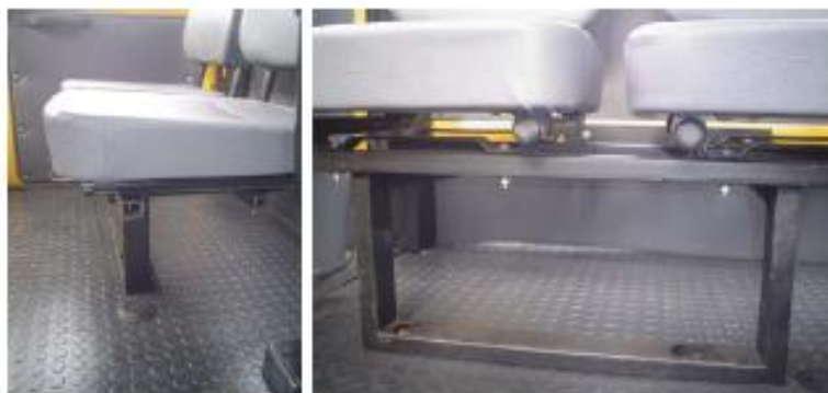
Рисунок 3.13 - Существующая схема крепления сидений
