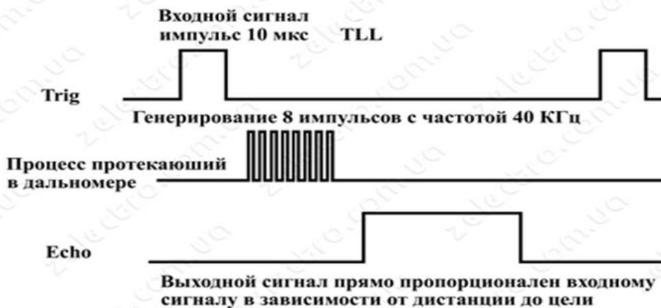
Рисунок 2.3 - Диаграмма работы ультразвукового дальномера HC-SR04
