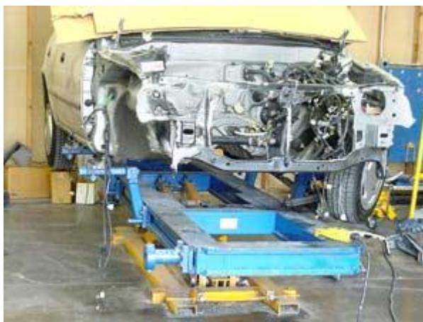
Рисунок 2.4 - Рихтовочный стенд марки «CAR-O-LINER»
