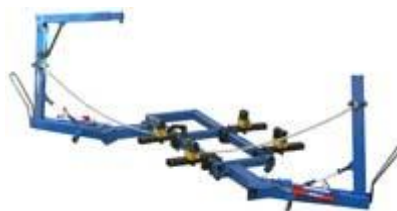
Рисунок 2.2 - Рихтовочный стенд марки «Мастер»
