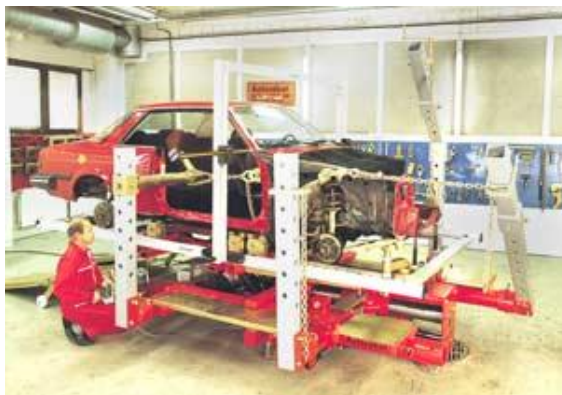
Рисунок 2.5 - Рихтовочный стенд марки «Autorobot»
