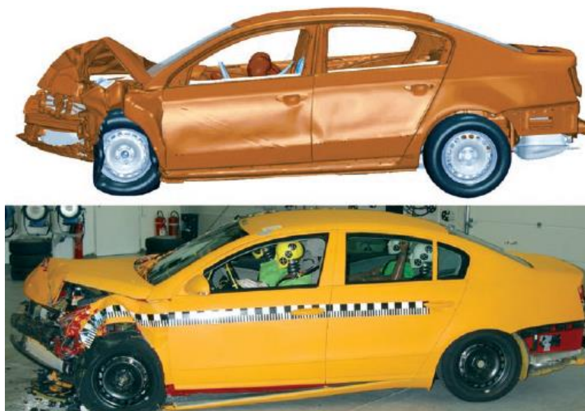
Рис. 1.31. Сравнительный анализ разрушений автомобиля, выполненный компанией Volkswagen
