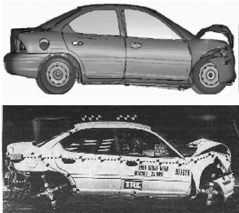
Рис. 1.32. Расчётная и фактическая деформации автомобиля Додж Неон
