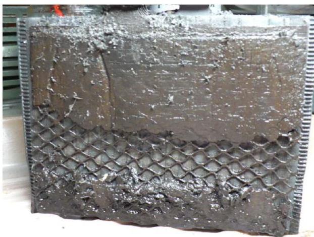
Рисунок 4.4 – Состояние положительного электрода аккумулятора батареи 6СТ-50, выслужившего установленный срок службы
