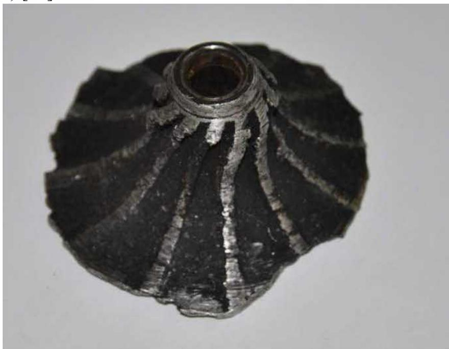
**Рисунок 1.5 - Разрушение компрессорного колеса в результате попадания постороннего предмета**
