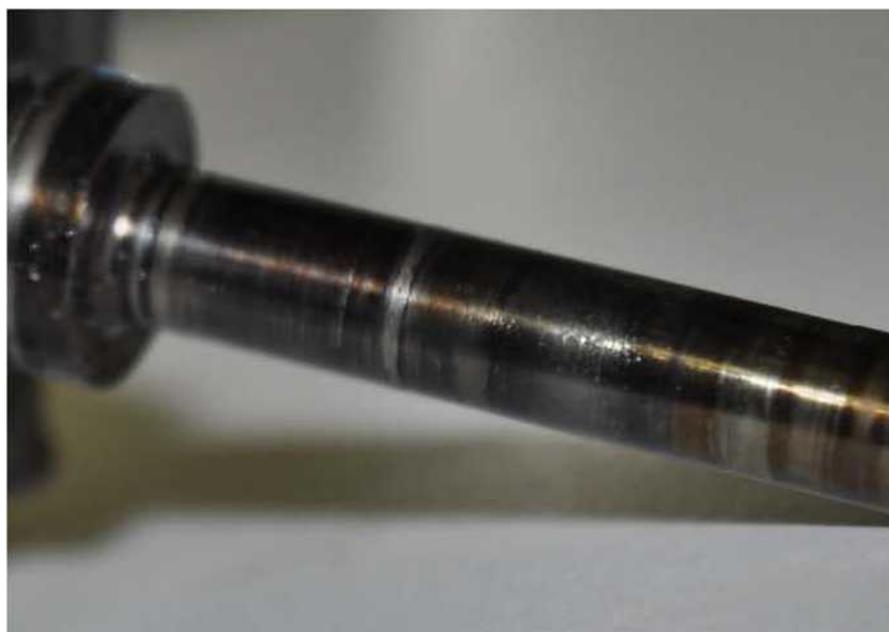
**Рисунок 1.4** - Механический износ на валу турбокомпрессора
