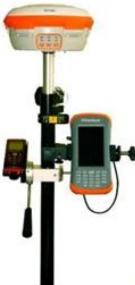
*Рисунок 23 – Комплект аппаратуры EFT M1 GNSS*
