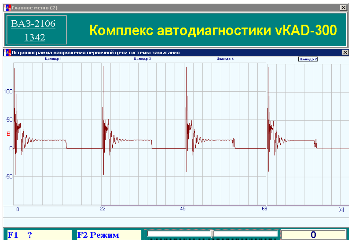
Рисунок 1.22. Осциллограмма изменения напряжения первичной цепи системы зажигания
