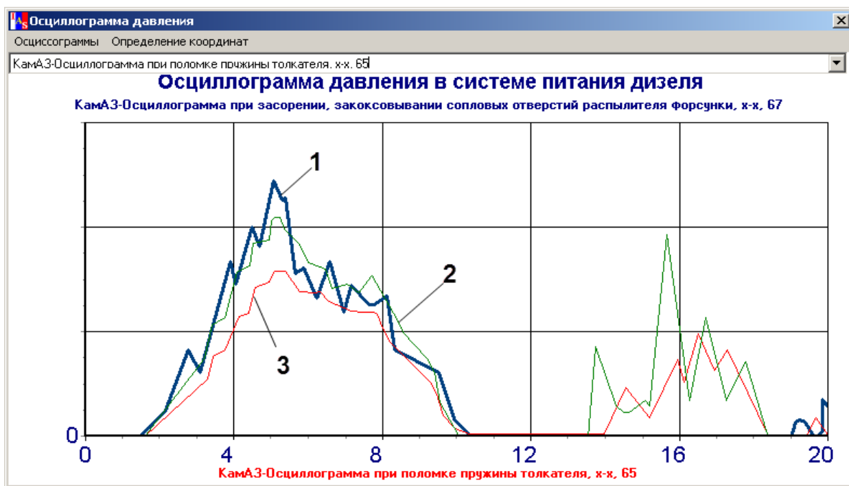
Рисунок 1.15 - Окно с осциллограммами комплекса КАД-400
