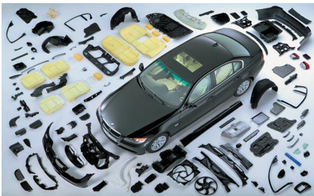
Рис 2.2 Пример частичной разборки автомобиля для утилизации
