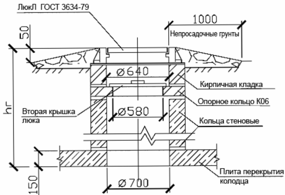
Горловина колодца для временной нагрузки 4,9кПа
