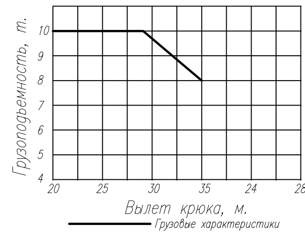
Грузовая характеристика крана КБК -504.1
