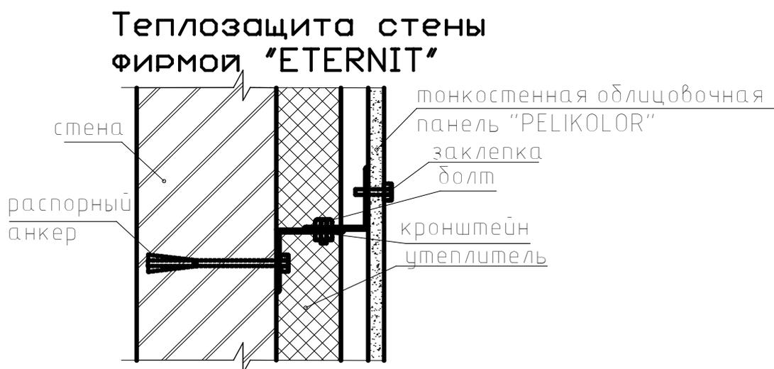
Рис.2.7 Технология утепления стены.
