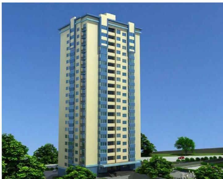
Одна из важных особенностей монолитных домов — это отсутствие в нем монтажных швов. Благодаря этому здания обладают высокой устойчивостью, уменьшается проникновение в них постороннего шума, а также значительно сокращаются потери тепла. Что касается внешней отделки, то ее можно осуществить с помощью фасадной плитки, кирпича или любых других отделочных материалов.
