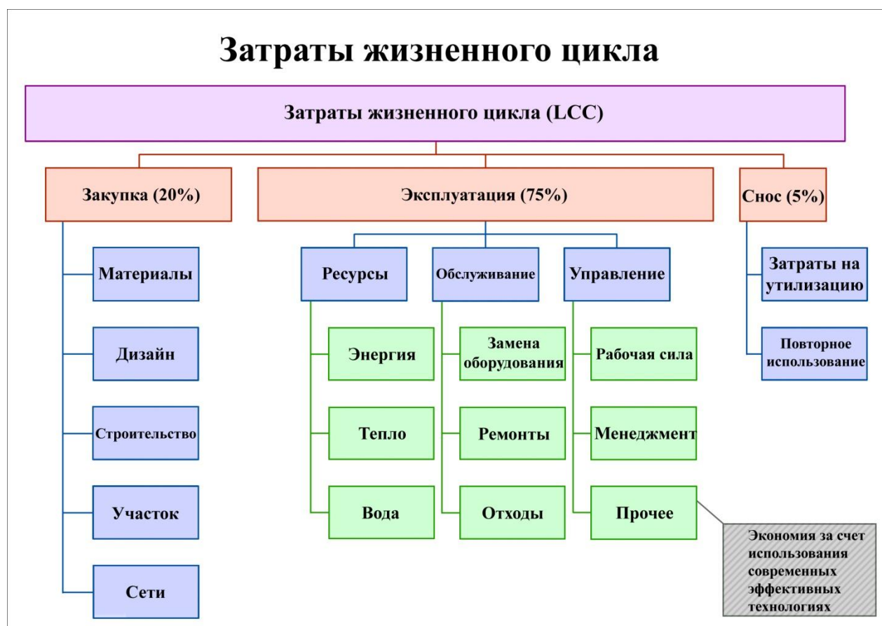
Рисунок 10 – Основная структура жизненного цикла и распределения затрат в рамках методики расчета жизненного цикла жилого здания с учетом стоимости совокупных затрат
