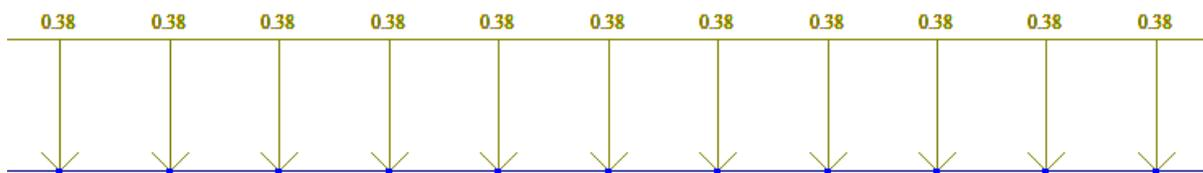
Рис. 2.4. Загружение 2. Постоянная нагрузка от покрытия
