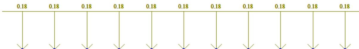
Рис. 2.5. Загружение 3. Снеговая нагрузка
