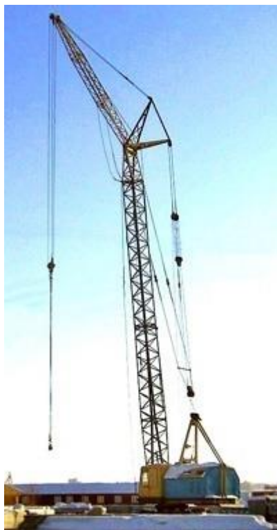
Рисунок 5.1 – Стреловой самоходный монтажный гусеничный кран МКГ-25БР
