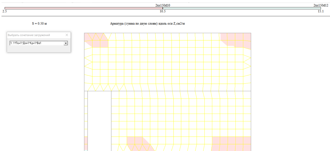
Рис. 2.4.15 Результаты армирования по оси Z стены См7-4
