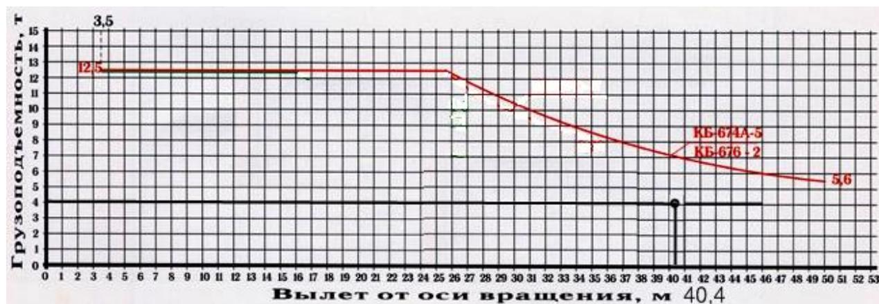
Рисунок 4.2 - Грузовая характеристика башенного крана КБ 676-2
