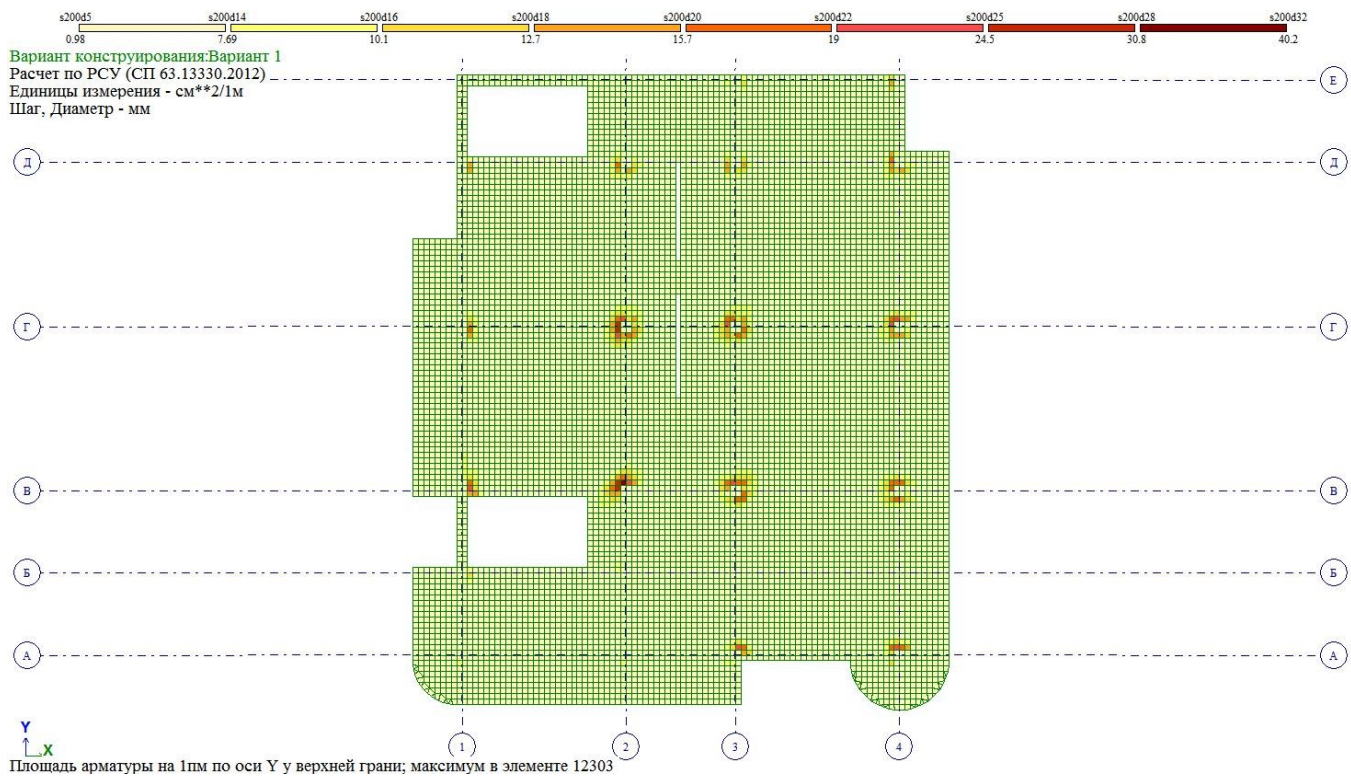
Рисунок 22 – Площадь арматуры по оси Y у верхней грани
