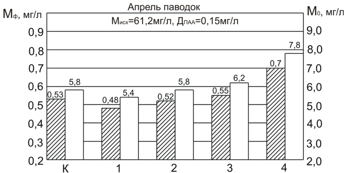
Рис. 4.24. Диаграммы остаточной мутности воды после отстаивания и фильтрования при двухступенчатом перемешивании вспомогательного объема воды с воздухом ( \varphi=0,1 ), СА ( D_1=36,0 мг/л) и ПОХА ( D_2=6,0 мг/л) для значений P_y : 1 – 7%; 2 – 5%; 3 – 3%; 4 – 1%; К – контрольная проба, обработанная СА с дозой D_k=60,0 мг/л ▨ – фильтрат (левая шкала); □ – вода после отстаивания (правая шкала)
