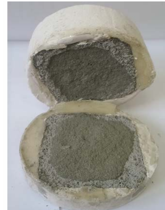
Рис. 4. Образец плиточного клея на цементной основе после проведения испытания
