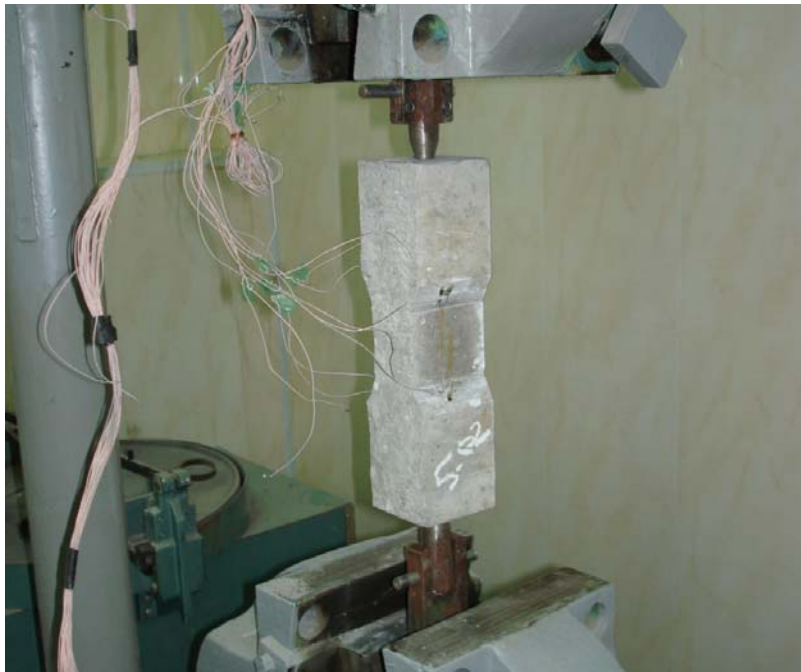
Рис. 4. Общий вид испытания образцов-«восьмерок» на центральное растяжение с помощью гидравлического пресса УММ-50
