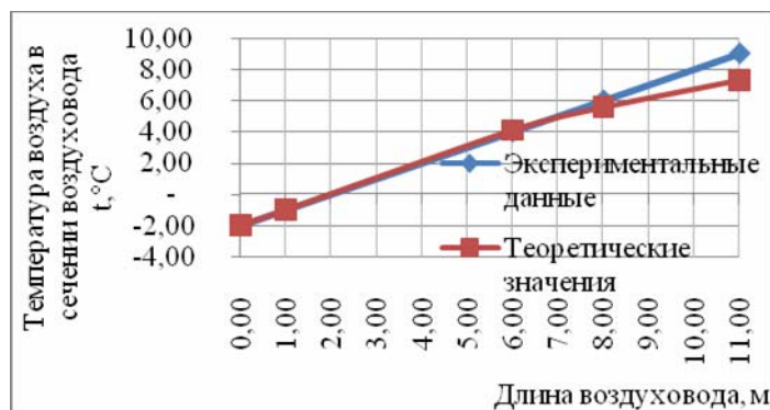
Рис.2. Распределение температуры t_x по длине воздушной прослойки воздуховода
